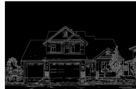
(d) Canny. Hysteresis threshold: 100 and 200
